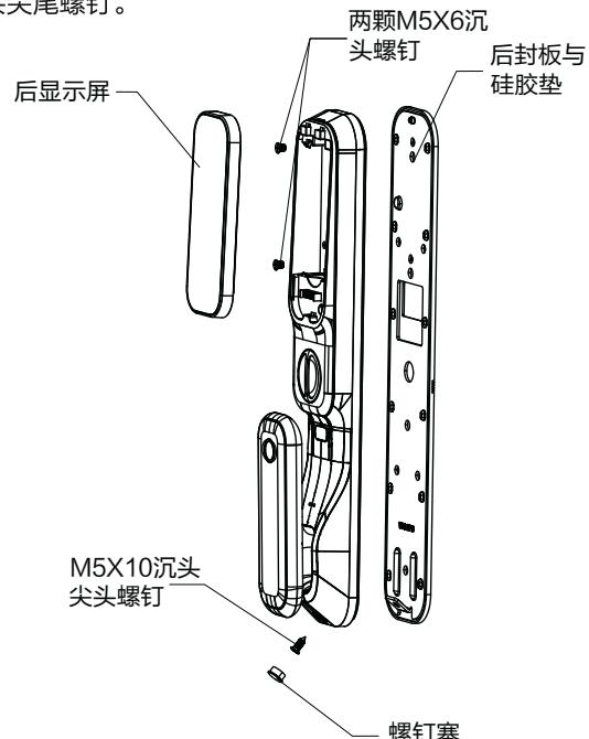
(2) 将前面板的方钢对准锁体方钢孔穿过，前面板对位的连接螺杆对准锁体定位孔插入。螺丝包中取出两根M6连接螺杆，根据门厚裁切到合适长度，将上一步取下的后封板与前面板固定锁紧并且把锁体连接线和前后对接线穿过后封板。
