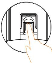
把需要录入指纹的手指放到指纹采集器上，用适度的力按压，听到嘀一声后，语音提示“请继续录入”，此时，需拿开手指稍微调整按压位置，用同一手指再按压指纹采集器，重复上次操作，录入5次指纹后，语音提示“指纹添加成功”，（注：5次录入指纹必须为同一手指，否则容易出现误识别）
