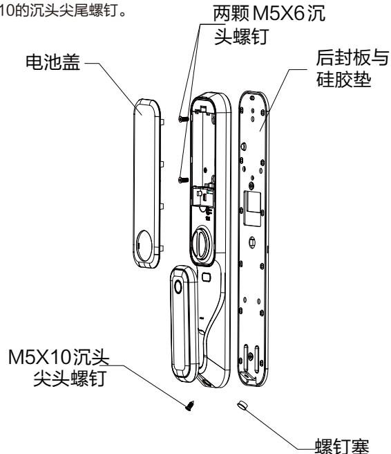
(2) 将上一步取下的后封板与前面板固定锁紧并且把锁体连接线和前后对接线穿过后封板。
