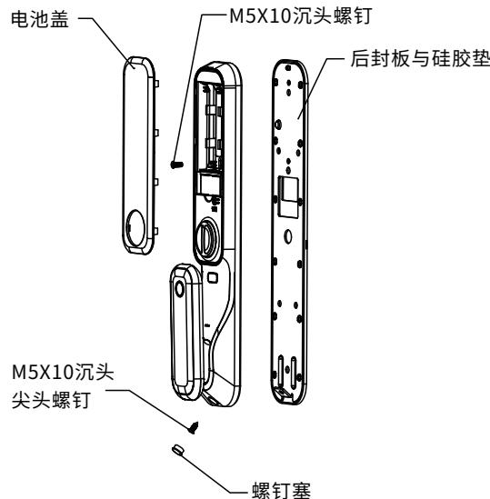
(2)将前面板的方钢对准锁体方钢孔穿过，前面板对位的连接螺杆对准锁体定位孔插入。螺丝包中取出两根M6连接螺杆，根据门后裁切到核实长度，将上一步取下的后封板与前面板固定锁紧并且把锁体连接线和前后对接线穿过后封板。
