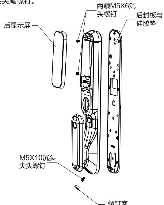
(2) 将前面板的方钢对准锁体方钢孔穿过，前面板对位的连接螺杆对准锁体定位孔插入。螺丝包中取出两根M6连接螺杆，根据门厚裁切到合适长度，将上一步取下的后封板与前面板固定锁紧并且把锁体连接线和前后对接线穿过后封板。
