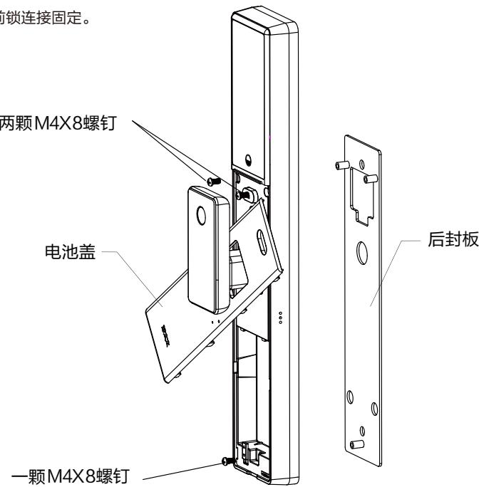
(2) 将合适长度的方钢置于锁体转轴孔内，方钢短的一侧必须向着锁体装入，将前锁的方钢孔对准锁体方钢，前锁对位的连接螺杆对准锁体定位孔插入，前锁贴合在门上。然后把猫眼连接线、天线连接线、前锁对接线、锁体连接线穿过门上过线孔和后封板方形通孔，根据门厚选取配件包中取出两根合适长度的M6连接螺杆固定前锁与后封板，连接螺杆要用力拧紧。
