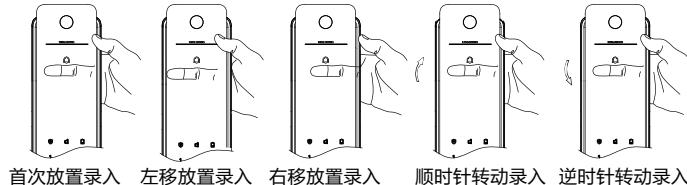
1. 录入指静脉时,请注意采集模块的左右两侧各有三个触摸感应点,录入指静脉时手指必须同时接触到两侧触摸感应点,如上图所示。
