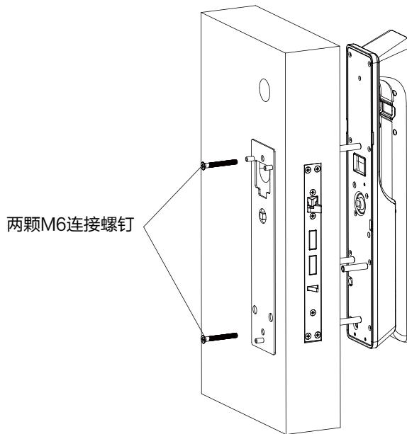
(3) 将前锁连接线、锁体连接线、猫眼连接线以及天线与后锁相应连接，将后锁的方钢孔对准装在锁体上的方钢插入，把第一步取下的3颗M4X8的螺钉重新安装并拧紧，最后盖上电池盖。
