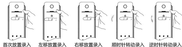
(1) 录入指静脉时，请注意采集模块的左右两侧各有三个触摸感应点，录入指静脉时手指必须同时接触到两侧触摸感应点，如上图所示。
