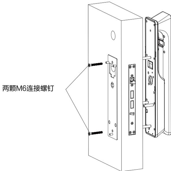
(3) 将前锁连接线、锁体连接线、猫眼连接线以及天线与后锁相应连接，将后锁的方钢孔对准装在锁体上的方钢插入，把第一步取下的3颗M4X8的螺钉重新安装并拧紧，最后盖上电池盖。
