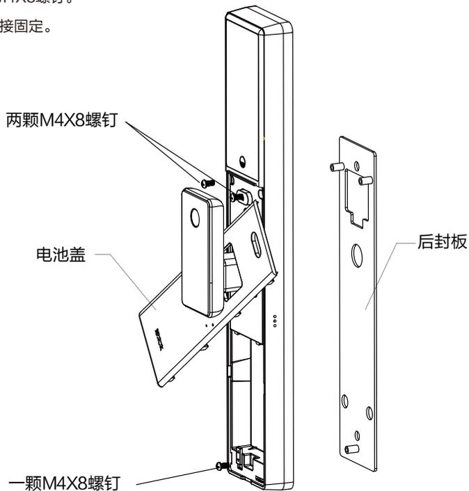
(2) 将合适长度的方钢置于锁体转轴孔内，方钢短的一侧必须向着锁体装入，将前锁的方钢孔对准锁体方钢，前锁对位的连接螺杆对准锁体定位孔插入，前锁贴合在门上。然后把猫眼连接线、天线连接线、前主板对接线、锁体连接线穿过门上过线孔和后封板方形通孔，根据门厚选取配件包中取出两根合适长度的M6连接螺杆固定前锁与后封板，连接螺杆要用力拧紧。
