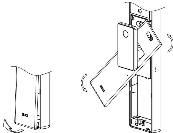
(2) 电池仓下方设置有橙色的锂电池拨钮。向下拨动拨钮，根据电池盒的接口指示放入5000mAh锂电池后，向上拨动拨钮，卡住锂电池底部。
