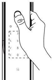
把需要录入指纹的手指放到指纹采集器上,用适度的力按压,听到嘀一声后,语音提示“请继续录入”,此时,需拿开手指稍微调整按压位置,用同一手指再按压指纹采集器;重复上次操作,录入5次指纹后,语音提示“指纹添加成功”,(注:5次录入指纹必须为同一手指,否则容易出现识别错误现象)
