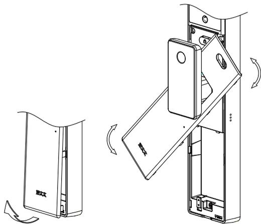
(2) 电池仓下方设置有橙色的锂电池拨钮。向下拨动拨钮，根据电池盒的接口指示放入5000mAh锂电池后，向上拨动拨钮，固定锂电池。
