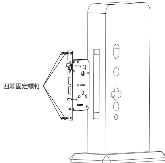
(2) 安装专用门框边条，在门框边条上装上四颗螺钉并旋紧装于门框上。
