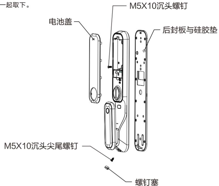
(2) 将前面板的方钢孔对准安装在锁体上的方钢，定位的连接螺杆对准锁体定位孔插入。螺丝包中取出两根M6连接螺钉，根据门厚裁切到合适长度，将上一步取下的后封板与前面板固定锁紧并且把锁体连接线、视频对讲天线以及前后对接线穿过后封板。
