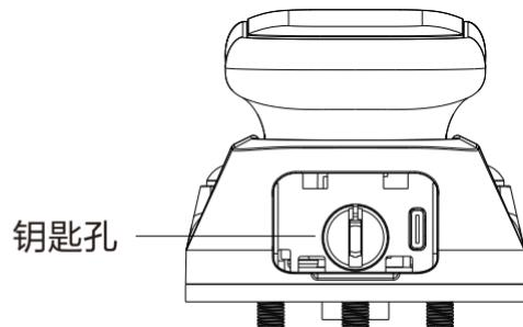
备注：应急钥匙孔位于前面板底部，需扣缺口位取下锁芯盖。
