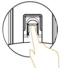
把需要录入指纹的手指放到指纹采集器上，用适度的力按压，听到嘀一声后，语音提示“请继续录入”，此时，需拿开手指稍微调整按压位置，用同一手指再按压指纹采集器；重复上次操作，录入5次指纹后，语音提示“添加成功”，（注：5次录入指纹必须为同一手指，否则容易出现误识别）
