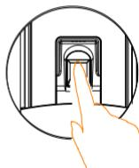
把需要录入指纹的手指放到指纹采集器上，用适度的力按压，听到嘀一声后，语音提示“请继续录入”，此时，需拿开手指稍微调整按压位置，用同一手指再按压指纹采集器；重复上次操作，录
