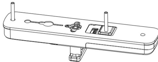
2.5 先将一根方轴插入门外一侧的锁体方轴孔中，再把前面板的连接线穿过门，使前面板贴紧门
