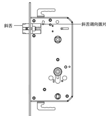
1. 使用螺丝刀卸下换向螺丝;
