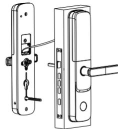
2.7 将弹簧放入后面板执手孔中，执手孔对准锁体上的方轴，反锁拨片对准锁体上的反锁拨片插口并插入，使后面板贴紧门，锁紧2颗面板固定螺钉
