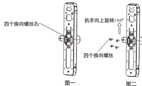
1. 使用带磁铁螺丝刀卸下换向螺丝;
