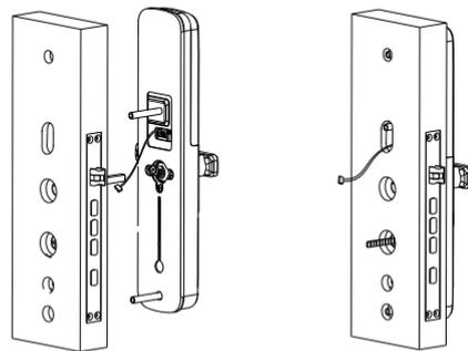
注：方钢长度=门厚+21~26mm，如门厚为40mm，所需方钢长度=40+23=63mm
