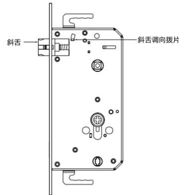
1. 使用螺丝刀卸下换向螺丝;
