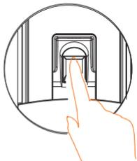
把需要录入指纹的手指放到指纹采集器上，用适度的力按压，听到语音提示“请拿开手指，再按1次”时，拿开手指稍微调整按压位置，用同一手指再按压指纹采集器；重复上次操作，录入5次指纹后，语音提示“添加成功”，（注：5次录入指纹必须为同一手指，否则容易出现误识别）。
